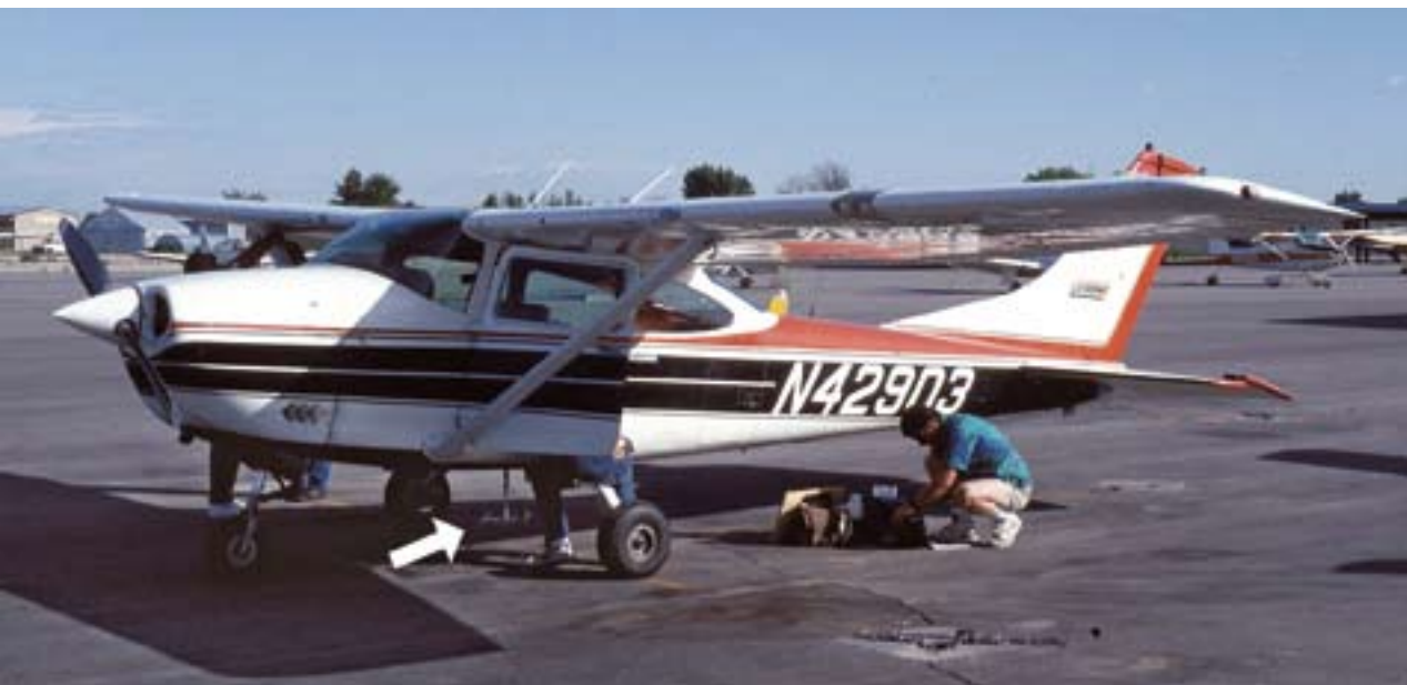
A repülőgép aljára szerelt antennával is könnyen meghatározható az adó iránya (lent).
