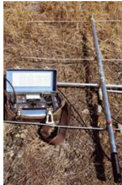
Ami a kereséshez szükséges: vevőkészülék és antenna (jobbra).
